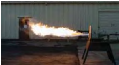
10 MMBtu/hr, 70% 分段燃燒狀況的燃燒試驗 Cleanfire® HRj™ 扁平火焰燃燒器
